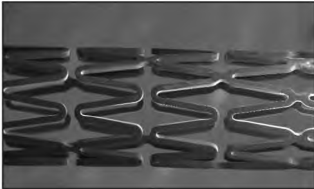
Рис. 1. Стент «Синус» ×50. Растровая электронная микроскопия.
