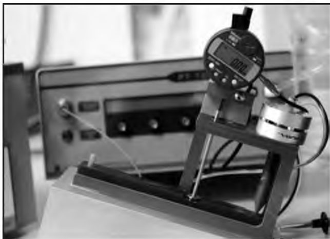
Рис. 7. Устройство для нагнетания давления в баллонный катетер.
