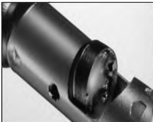
Рис. 2. Режущий элемент из высокоуглеродистой стали.
