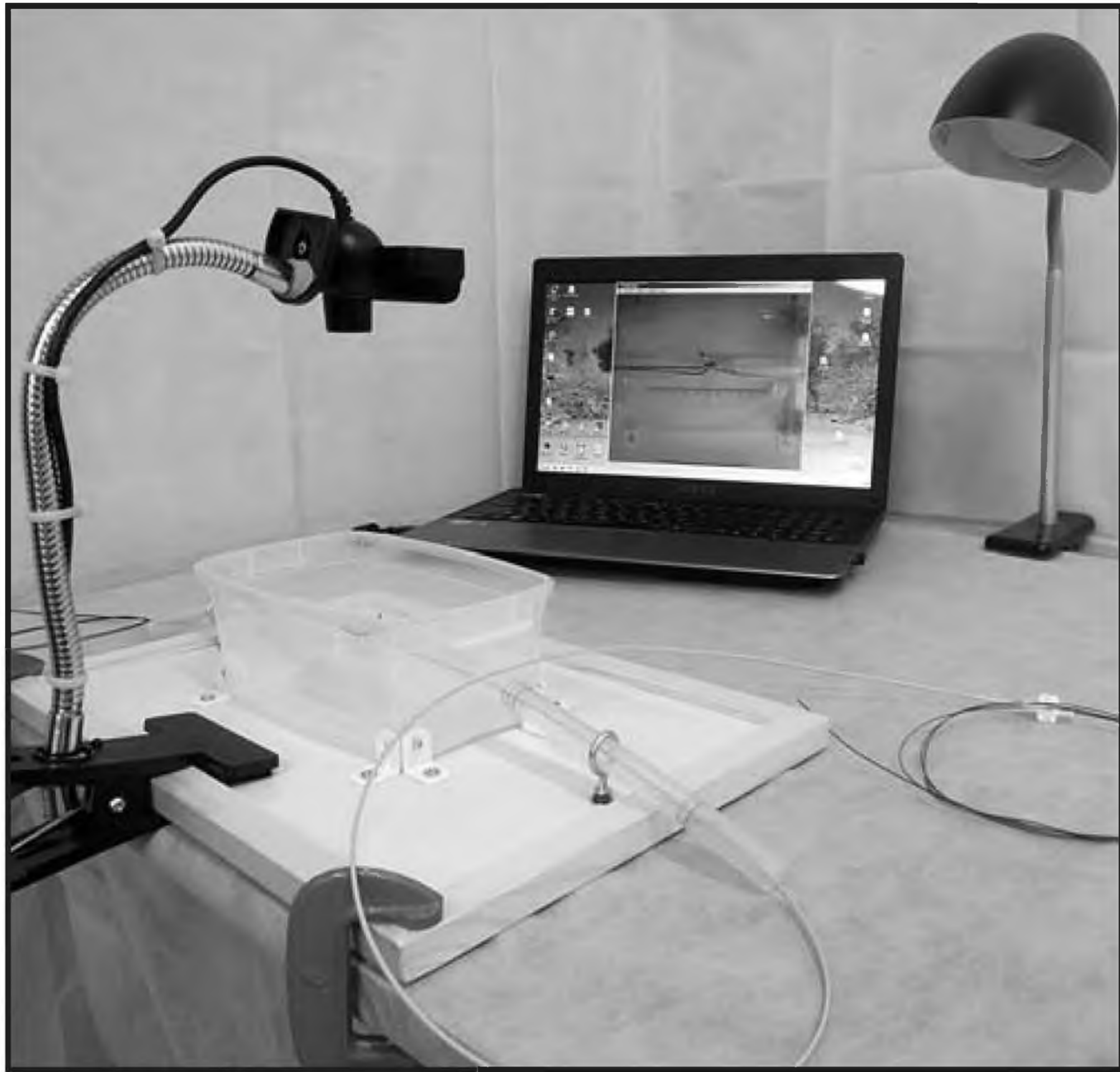
Рис. 1. Стенд для отработки эндоваскулярного вмешательства на поврежденном сосуде.
