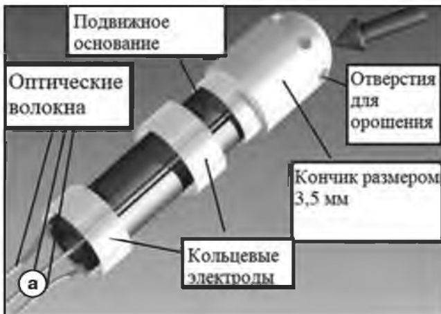
Рис. 1. Структура катетеров с датчиком давления на ткань. а - катетер Tacticath Quartz Contact Force, Endosense/St Jude Medical ; б - катетер Thermocool SmartTouch CF, Biosense Webster .
